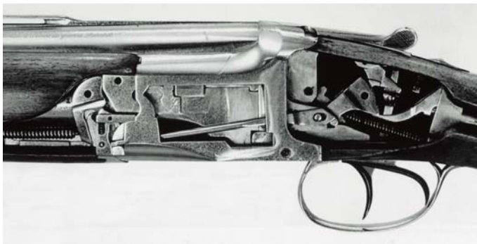
Przekrój szkoleniowy jednego z prototypów Superposé z roku 1930, jeszcze z dwoma spustami. Przejście na pojedynczy język spustowy było jedyną poważną zmianą konstrukcyjną w ciągu 80 lat
